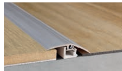
Perfil combinado PGPRSILV, 1860 x 47 mm Perfil en T y junta reductora en uno. Guía inferior de plástico. Indicado para diferencias de altura de 0 – 12,3 mm. Altura: 10 mm (sin instalar). Color: plateado. Superficie: aluminio.
